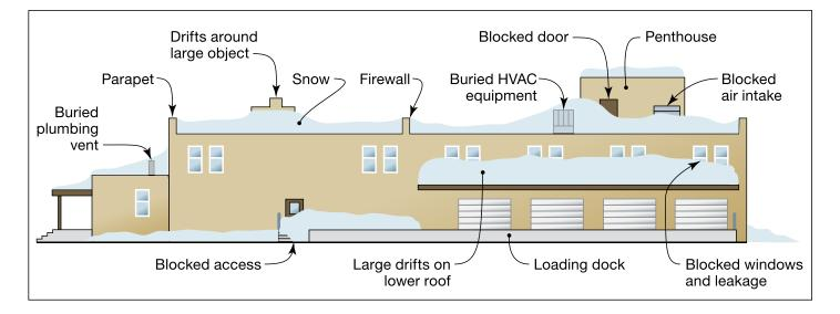
UNBALANCED SNOW AND DRIFTING ON A TYPICAL COMMERCIAL BUILDING
